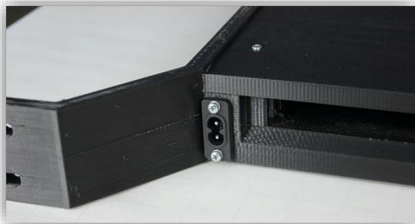
В случае установки внутрь корпуса ИБЭП типа РТК.23.11 – на разъеме, показанном на фото слева, будет выдаваться выходное напряжение с ИБЭП, которое можно будет отключать включателем корпуса.
